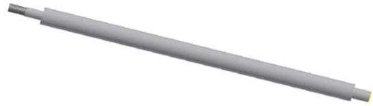
Gambar 4 Gambar poros utama mesin bubut kayu sederhana
