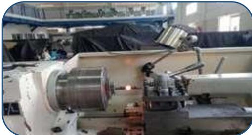
Gambar 4 Proses *friction welding* dengan mesin bubut
