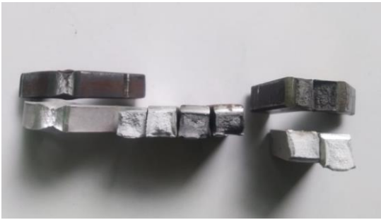
Gambar 8. Jenis Patahan pada spesimen Baja AISI dan Aluminium 20x
