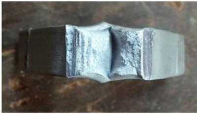
Gambar 7. Patahan Spesimen 2
