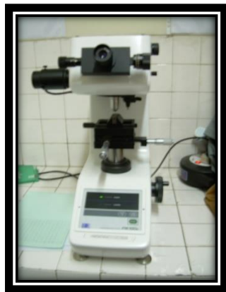
Gambar 3.6 Mesin uji keras mikro vickers
