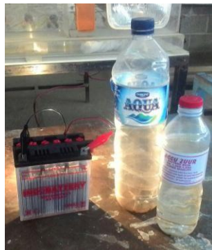
Gambar. 3.8 Proses pengujian baterai dengan komposisi 35% Asam Sulfat + 65% Air Aqua
