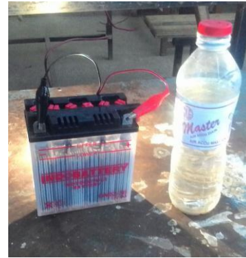
Gambar. 3.6 Proses pengujian Baterai dengan komposisi 100% Asam Sulfat
