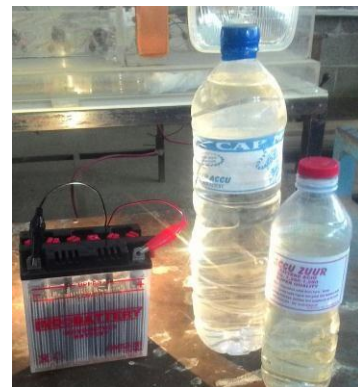
Gambar. 3.7 Proses pengujian baterai dengan komposisi 35% Asam Sulfat + 65% Air Suling
