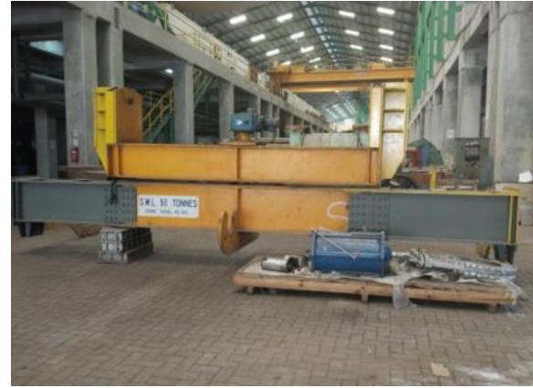
Gambar 2 Modifikasi rotary crane lengan tambahan
