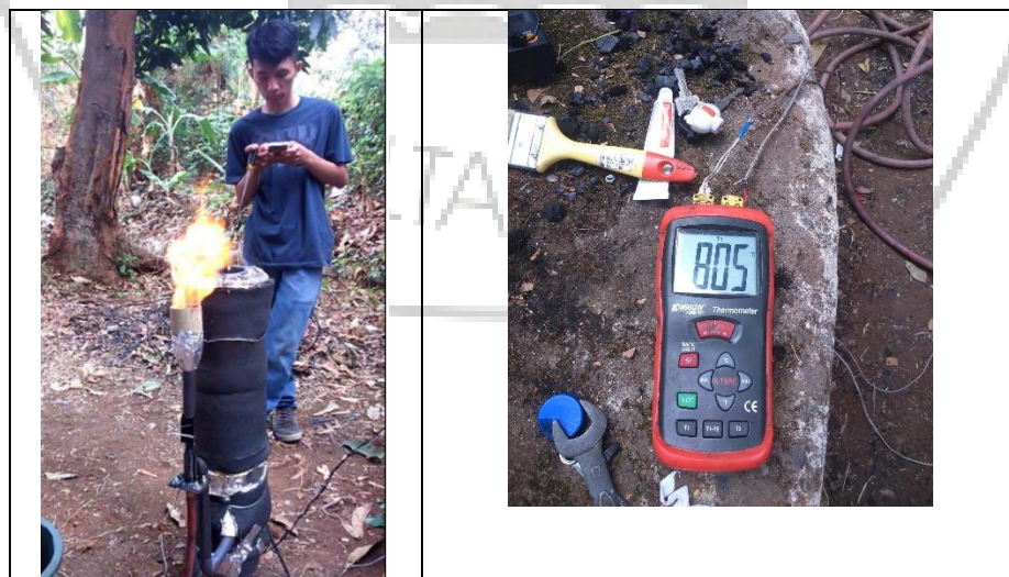
Gambar 6. Pengujian Nyala Api dan Pengukuran Temperatur Reaktor
