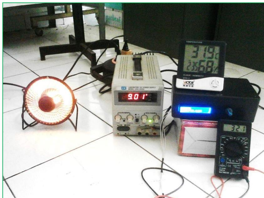
Gambar.12. Pemanas Elektrik Dalam Kondisi Menyala ketika suhu  $< 35^{\circ}\text{C}$
