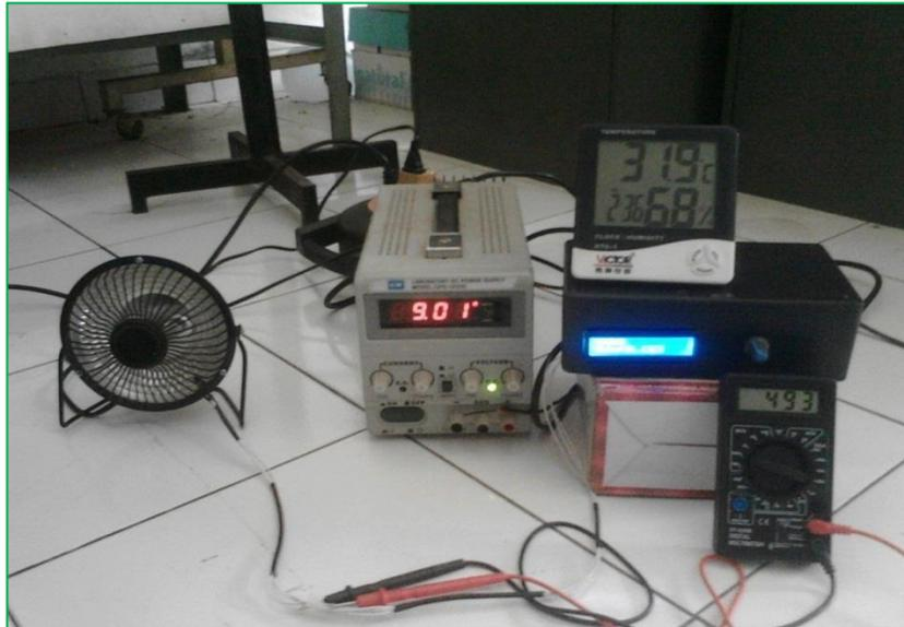
Gambar 13. Pemanas Elektrik Dalam Kondisi Menyala ketika suhu  $> 35^{\circ}\text{C}$
